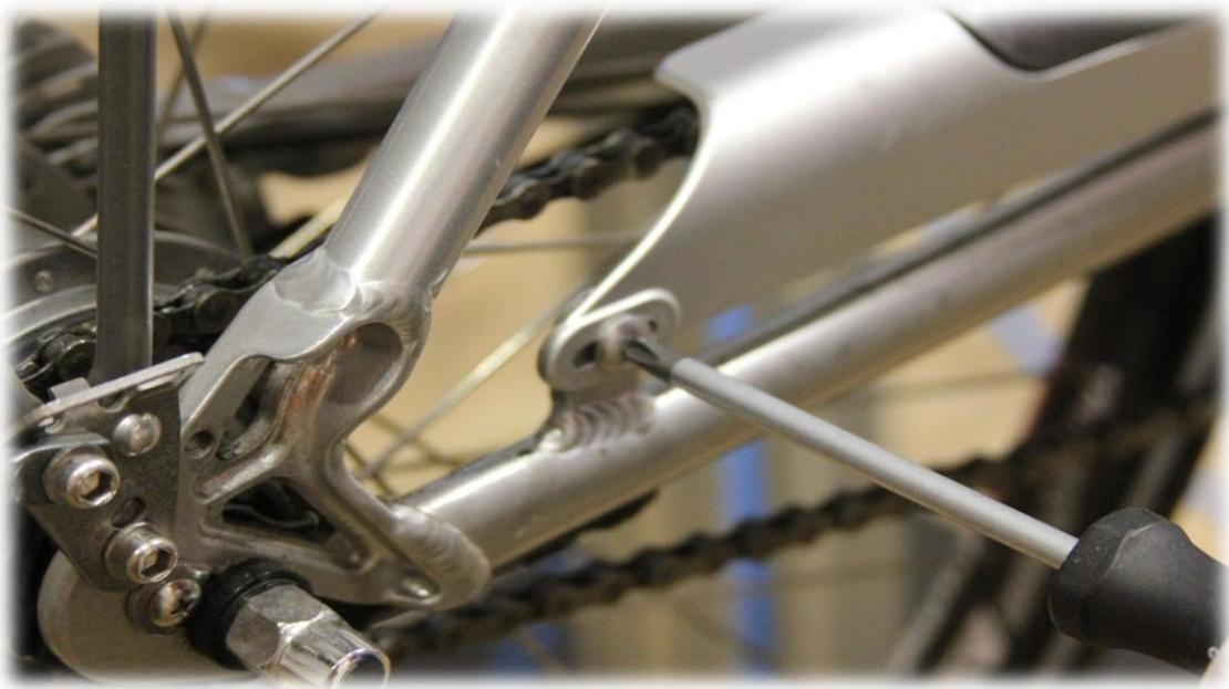
Ziehen Sie den gelösten Kettenschutz nach vorne von der Klemmplatte am Motor ab
