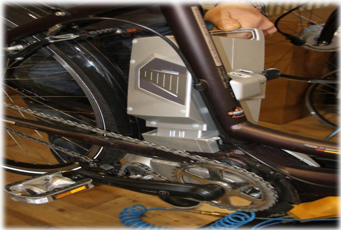
Schrauben Sie die Verkleidung auf der gegenüberliegenden Seite ab und schieben wie beim Kettenschutz die Plastik nach hinten ab
