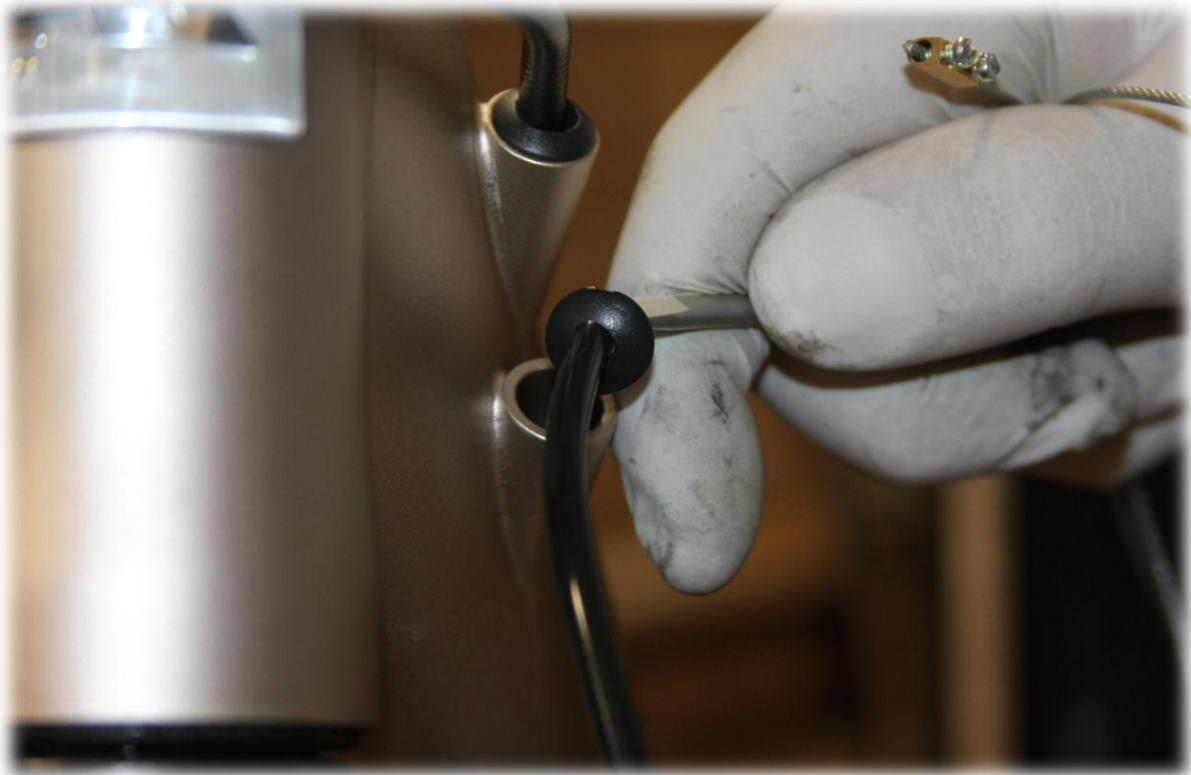
Führen Sie nun das Drahtseil durch die Öse des Masseanschlusses der Anfahr-/ Schiebehilfe, und dann in den offenen Rohrschacht des Lichtkabels, bis das Drahtseil unten am Motor irgendwo herauschaut.
